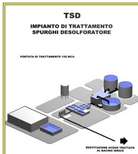
Figura n° 16 - Sistema di trattamento acque reflue DeSOx
