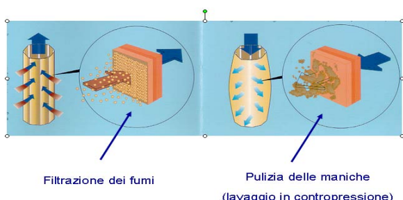
Figura n° 12 - Principio di funzionamento filtro a maniche
